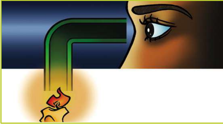
(5-3) شکل، د کور شوي نل په وسیله د شیانو لیدل
